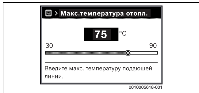
Рис. 7 Установка максимальной температуры подающей линии
