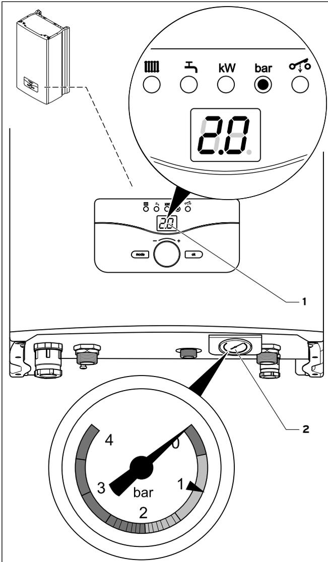
**6.1 Проверка давления наполнения системы отопления**
