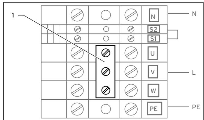
5.7 Установка перемычки для подключения к однофазной э/сети
