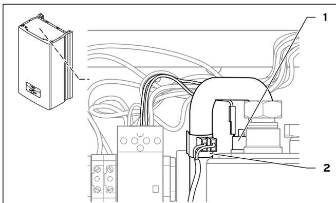
10.9 Датчик температуры NTC и тепловой предохранитель
