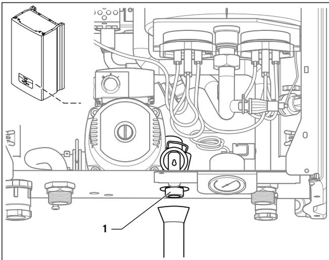
4.9 Выпускное отверстие предохранительного клапана
