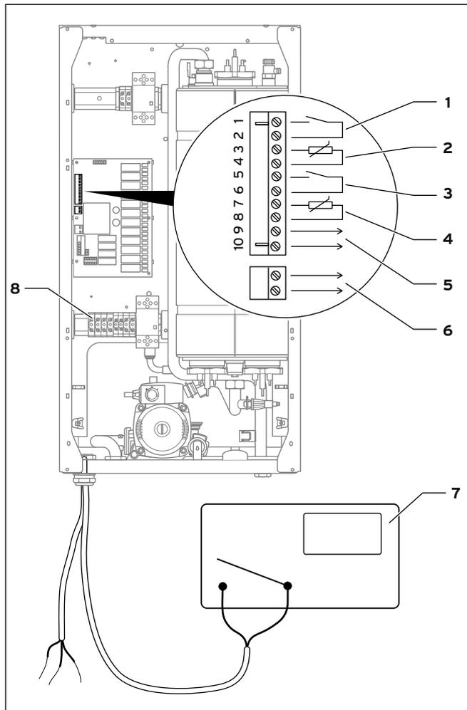
5.5 Priključci na utičnim spojevima K8 i K9
