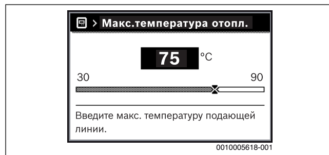
Рис. 25 Установка максимальной температуры подающей линии
