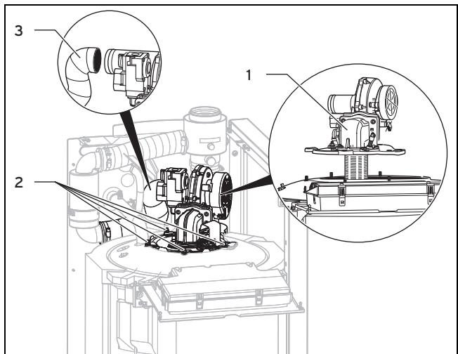
9. Отсоедините впускной воздушный шланг (3) от штуцера на вентиляторе.
