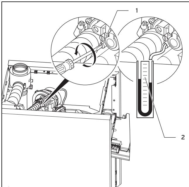
3. Выверните уплотнительный винт с обозначением "in" (1) на газовой арматуре.
