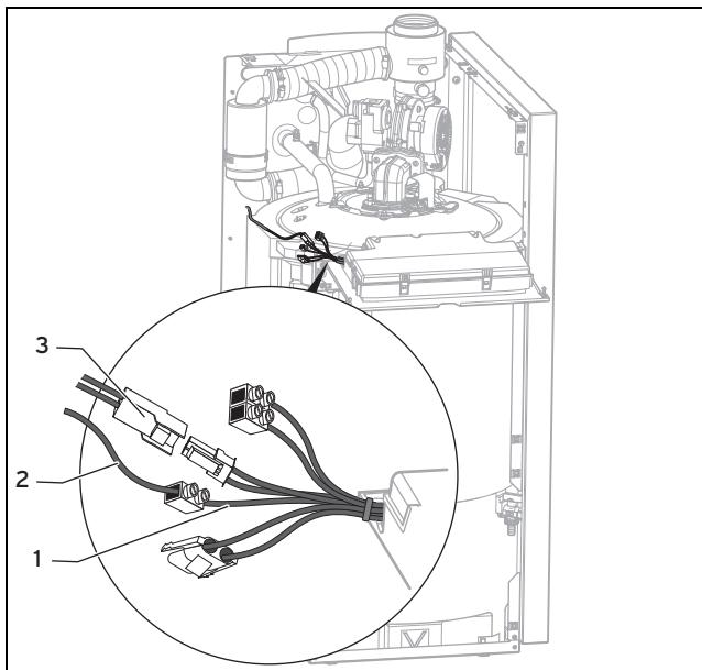
1. Подсоедините датчик температуры накопителя (3) и при наличии датчик температуры загрузки (2) (только actoSTOR, фиолетовый кабель соединения с распределительной коробкой (1)) к кабельному жгуту.
