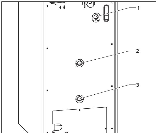
1. Установите между системой отопления и изделием необходимые защитные и запорные устройства (предоставляются монтажным предприятием), а также кран заполнения и опорожнения в обратной линии.
