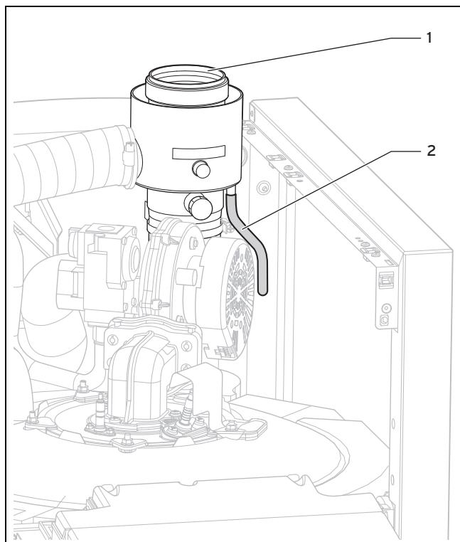
1. Перед наполнением сифона подсоедините линию отвода конденсата к обратной стороне изделия. Соблюдайте указания по прокладке линии отвода конденсата, приведённые в главе "Подключение линии отвода конденсата" (→ страница 15).
