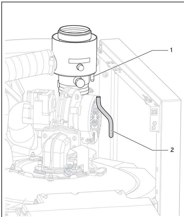
1. Отсоедините промывочную линию (2) от подключения системы воздуховодов/дымоходов(1).
