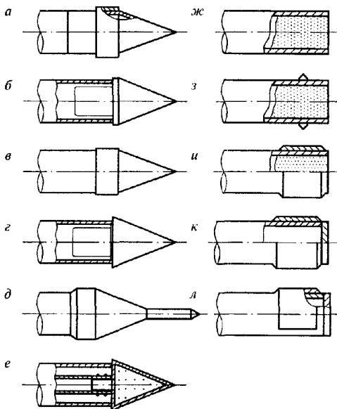
а, б, в - конусные наконечники; г - конусный наконечник с эксцентрикситетом; д - конусный наконечник с направляющей иглой; е - конусный наконечник с отверстиями для увлажнения грунта; жс - открытый конец футляра без наконечника; з - открытый конец кожуха с кольцом из круглой стали; и - кольцевой нож с наружным скосом режущих кромок; к - кольцевой нож с наружным скосом режущих кромок и приварной заглушкой; л - нож серпообразного сечения с приварной заглушкой
