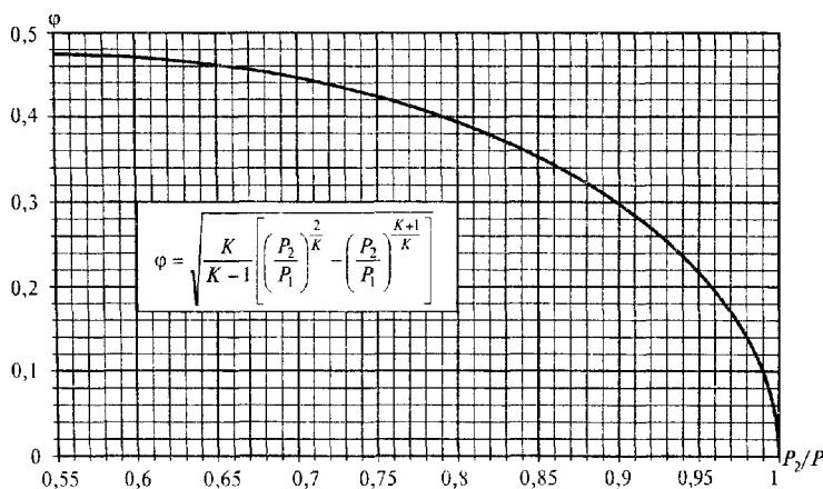
$K$  - показатель адиабаты газа при давлении 750 мм вод. ст. и температуре  $0^\circ\text{C}$ ,  $C_p$  - теплоемкость при постоянном давлении,  $\text{кал}/(\text{м}^3 \cdot ^\circ\text{C})$ ,  $C_v$  - теплоемкость при постоянном объеме,  $\text{кал}/(\text{м}^3 \cdot ^\circ\text{C})$
