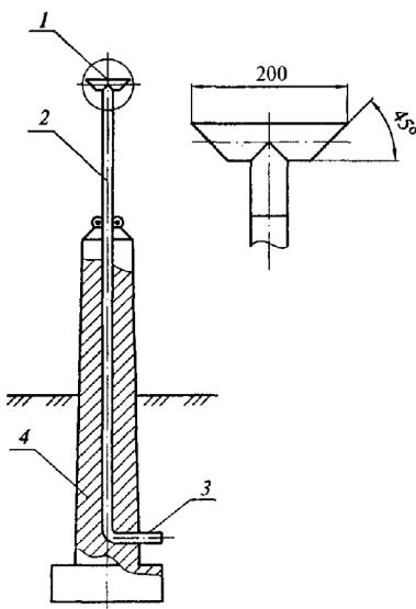
1 - оголовник; 2 - вытяжная труба; 3 - отводная труба; 4 - фундамент
