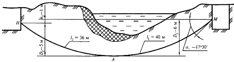
Рисунок Л.4 - Расчетные параметры пилотной скважины
