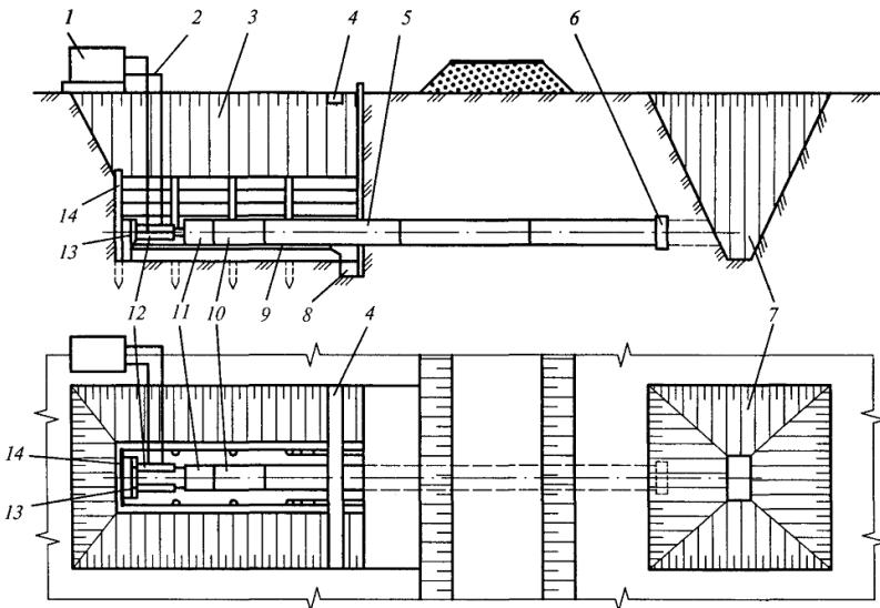
1 - насосная станция; 2 - газопровод; 3 - рабочий котлован; 4 - водоотводной лоток; 5 - защитный футляр; 6 - лобовая обделка (нож); 7 - приемный котлован; 8 - приемок для сварки защитного футляра; 9 - направляющая рама; 10 - нажимной патрубок; 11 - нажимная заглушка; 12 - гидродомкраты; 13 - башмак; 14 - упорная стенка
