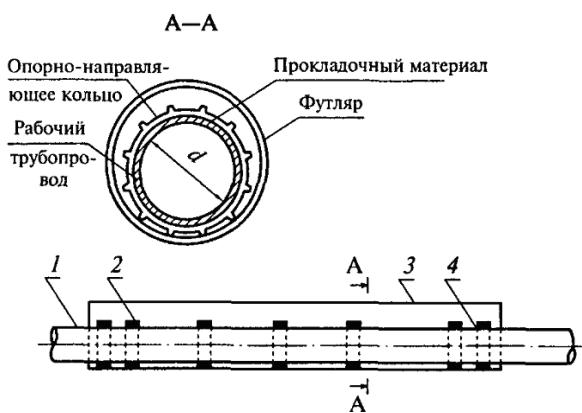
1 - газопровод; 2 - опорно-направляющее кольцо; 3 - футляр; 4 - прокладочный материал
