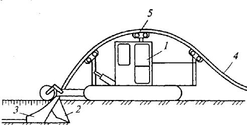
1 - гусеничный тягач; 2 - режущий нож; 3 - щелезасыпчик; 4 - трубная плеть; 5 - роликоопоры
