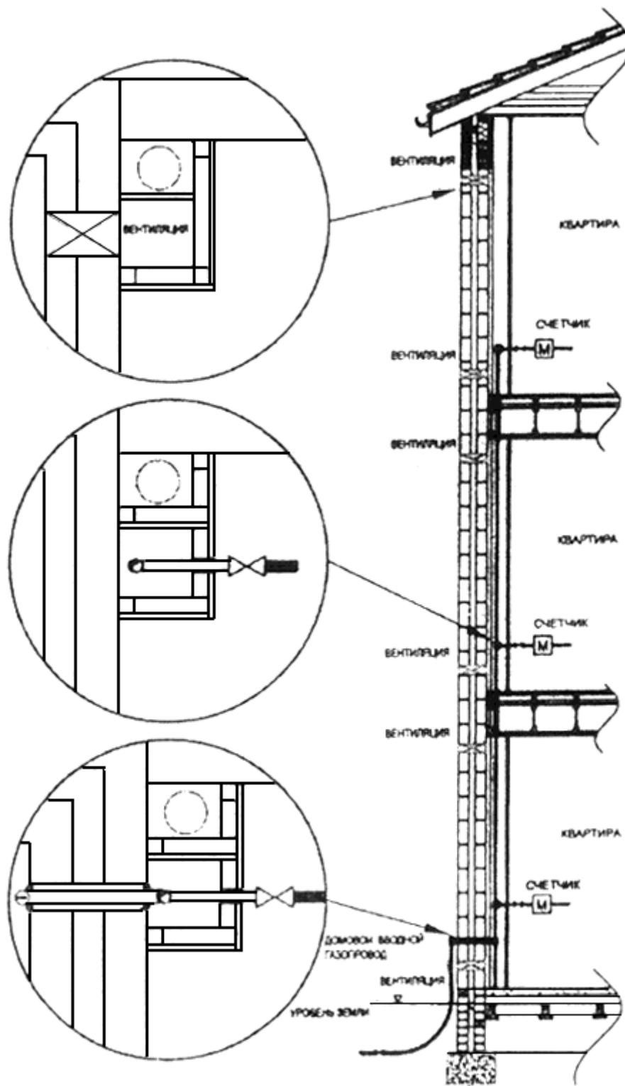
Рисунок Г.1 - Газопровод в вентилируемой штрабе
